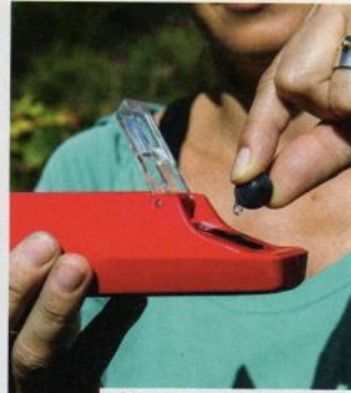
Réfractomètre qui mesure le taux de sucre et la maturité du raisin.
